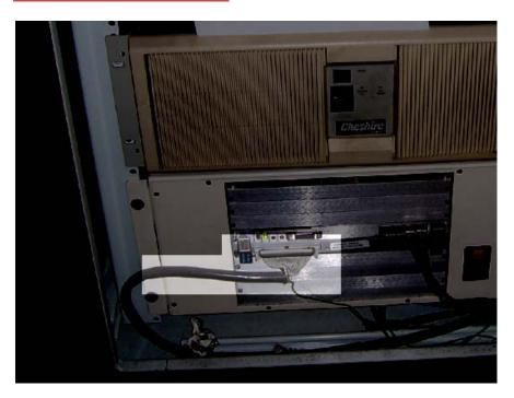
PAMUX CABLE INTO THE BACK OF A COMPUTER ENCLOSURE
